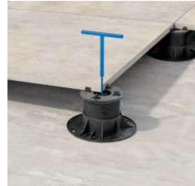
Grazie all'**apposita chiave**, i supporti PP level DUO MAXI con testa autolivellante per pavimenti in ceramica possono essere regolati in altezza anche a pavimento finito, per ottenere pavimentazioni perfettamente livellate. Per una regolazione più rapida, è disponibile un inserto in acciaio per avvitatore.
