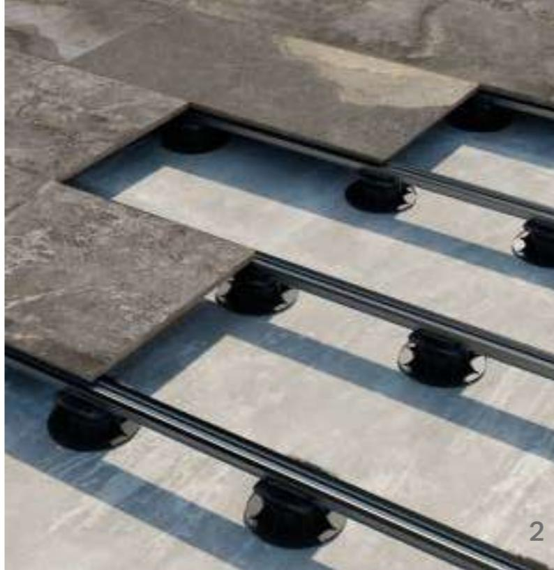
3. Sistema PP level DUO MAXI con testa ad incrocio (cod. 201026) e travetti in alluminio (cod. 201027) trasversali, per una maggiore stabilità in caso di altezze superiori a 40 cm.
