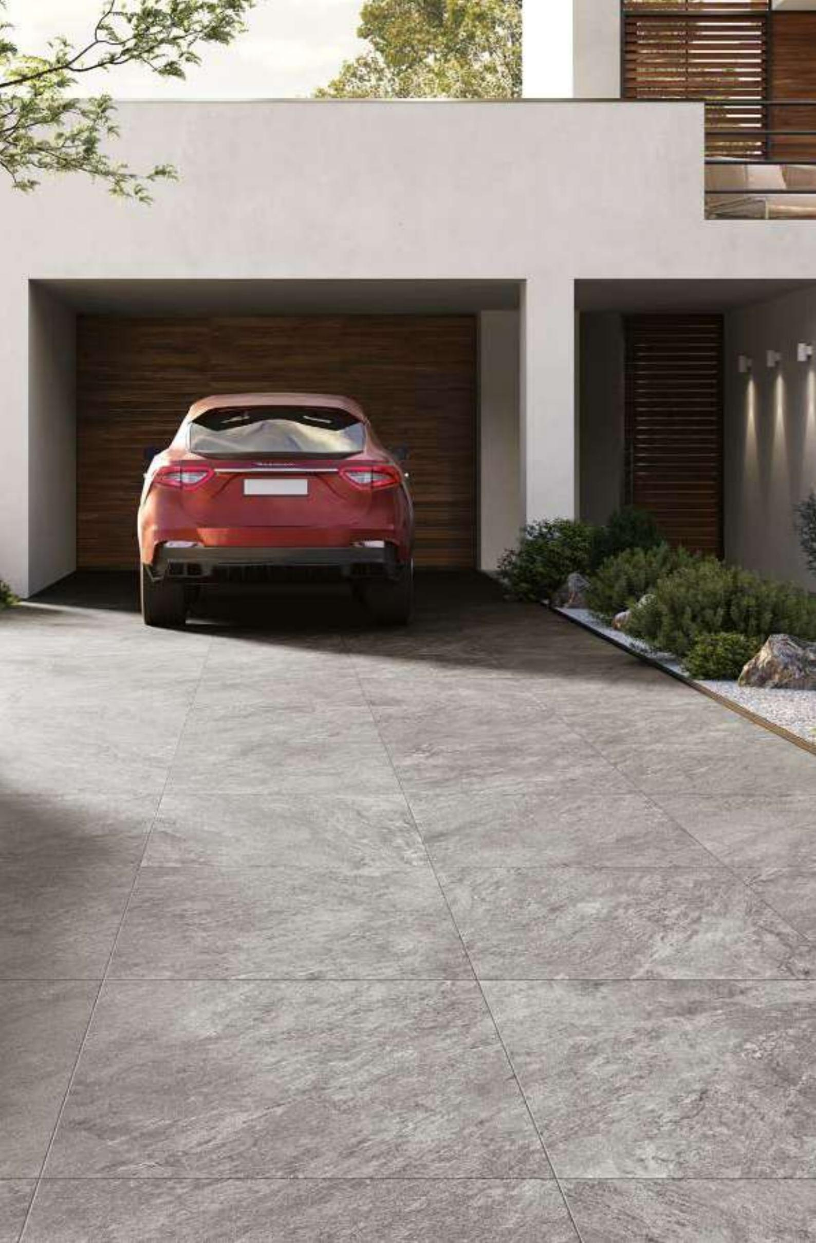
Dall'abbinamento della posa a colla su massetto tradizionale con le piastrelle a spessore 20 mm è possibile creare pavimenti da outdoor con elevate prestazioni tecniche. Sono pavimentazioni caratterizzate da una perfetta stabilità del fondo e un'eccezionale resistenza ai carichi di rottura concepite per superfici sottoposte al passaggio e alla sosta di autoveicoli o per aree altamente frequentate quali marciapiedi, piste ciclabili o camminamenti pedonali.
