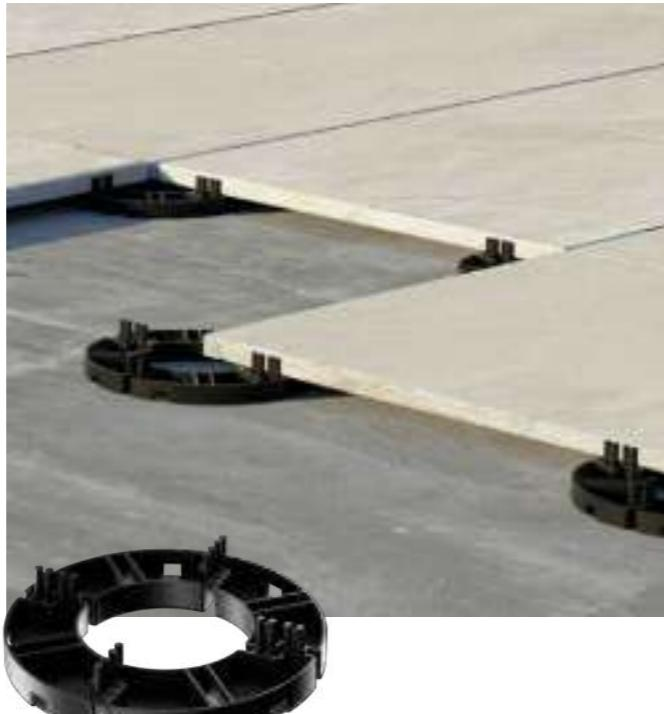
PP level MINI (cod. 201032) è un **supporto regolabile a testa fissa** e per altezze fino a 30 mm, a completamento della gamma. PP level MINI è regolabile in altezza da 10 a 15 mm, ma è ulteriormente estensibile fino a 30 mm inserendo un massimo di tre **prolonghe** (cod. 201033) da 5 mm ciascuna. PP level MINI è dotato di alette distanziatrici per fughe da 4 mm, facilmente removibili.
